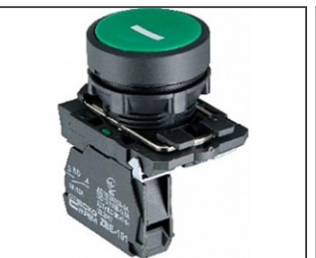
44574 TB5-AA3311 кнопка "СТАРТ" зелена потаємна без фіксації IP40 АСКО
